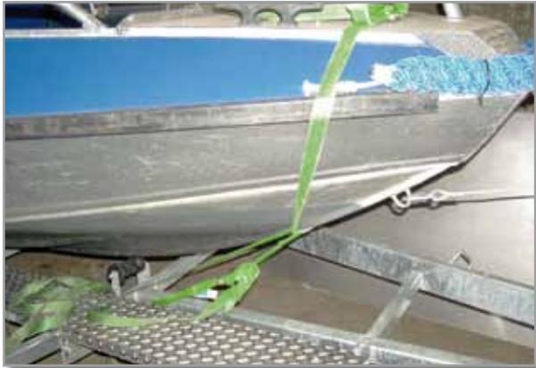
Werden Zurrgurte im Niederzurrverfahren eingesetzt, ist auf Vorspannkraft der Ratsche von mind. 200 daN (STF-Wert laut Etikett = 200 daN) zu achten.
